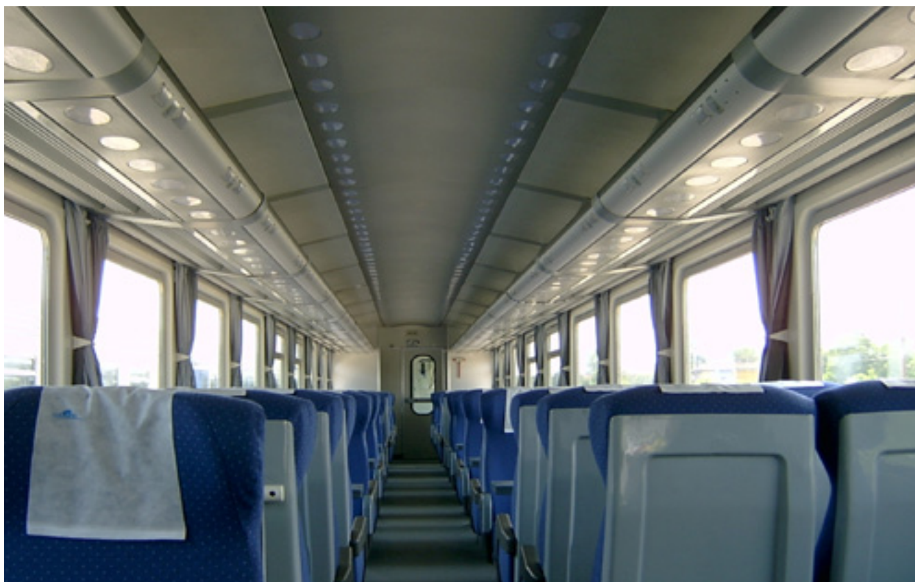
Masterplex 选用 LEXAN 板材设计意大利轨道车辆中最具挑战的内饰：整合了漫射灯的火车天花板。
