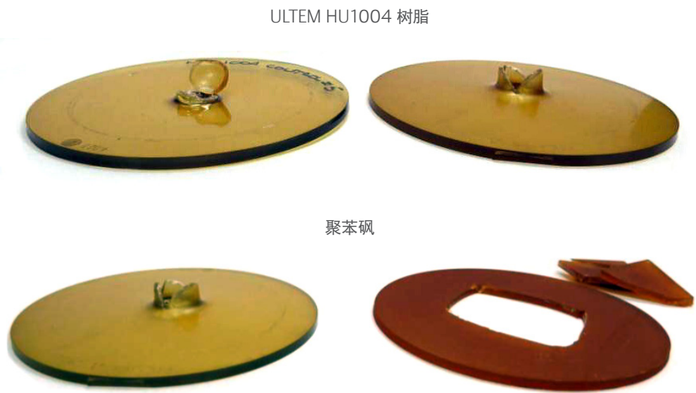
图 4 300 个 STERRAD NX 周期后 ULTEM HU1004 树脂与聚苯砜的多轴冲击。 左边样品为对照样品，右边样品为暴露后的样品。
